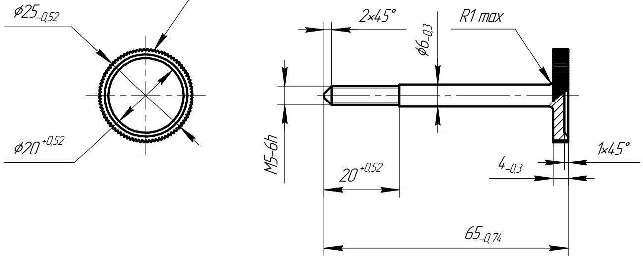
1. Допускается выполнять рифление сетчатое 0,8 ГОСТ 21474-75.
