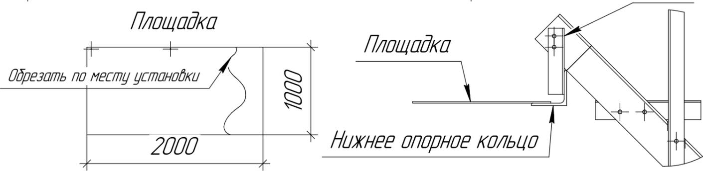
1. Лестница собирается на болтовых соединениях после окончания монтажа нижнего опорного кольца.
