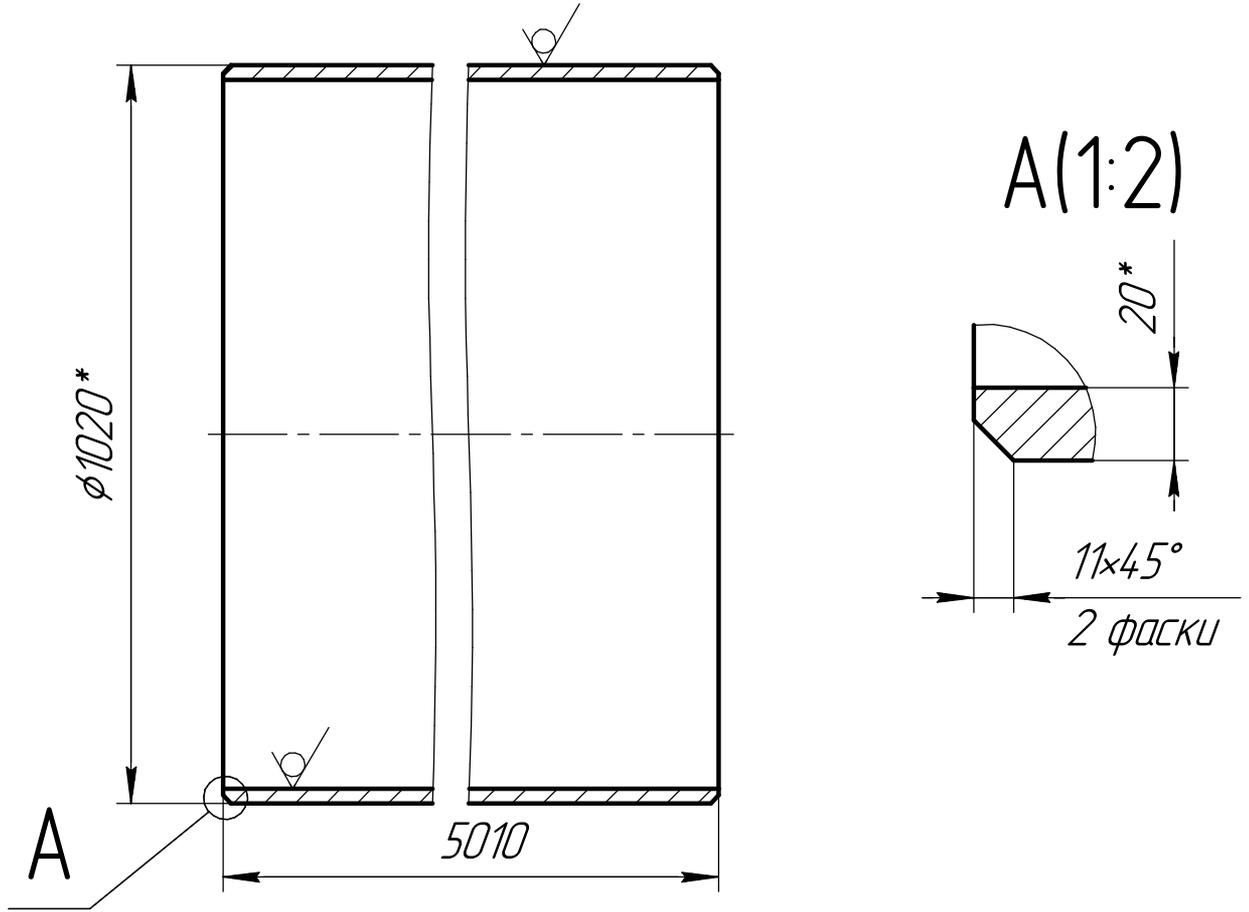
1 *Материал-заменитель: Труба*  $\frac{1020 \times 20 \text{ ГОСТ } 10704-91}{09Г2С \text{ ГОСТ } 10706-76}$ , *при условии проверки давлением не ниже 4 МПа.*
